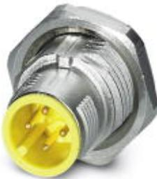
Встр. штекер шинной системы, с желтым держателем контактов, 4-контактн., M12-SPEEDCON, экранированный, с мех. ключом А, монтаж с задней стенки/винтовое крепление M16, с прямыми выводами под пайку
