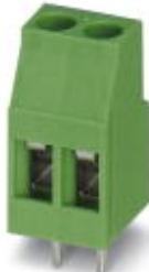
Клеммы для печатной платы, номинальный ток: 24 A, номинальное напряжение: 400 В, размер шага: 5,08 мм, полюсов: 5, тип подключения: Винтовой зажим с натяжной гильзой, монтаж: Пайка волной припоя, направление подключения, проводник/печатная плата: 0 °, цвет: зеленый
