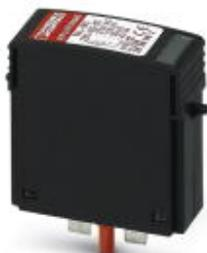
Штекерный модуль для защиты от импульсных перенапряжений, тип 2, с мощным варистором для базового элемента VAL-MS, контроль перегрева, визуальный индикатор неисправности. Исполнение: 230 В AC
