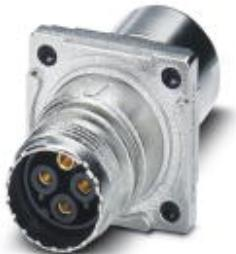
Проходная деталь, прямой, Крепление SPEEDCON, M17, полюсов: 3+PE, тип контактов: Розетка, Обжим, Плоское уплотнение, 4x Ø 3,2, экранирован.: есть, размер фланца: 25,75 мм x 25,75 мм, диапазон диаметра кабеля: 9 мм ... 11 мм
