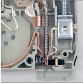
Контактная группа из серебросодержащего композита обеспечивает повышенную износостойкость выключателя.
