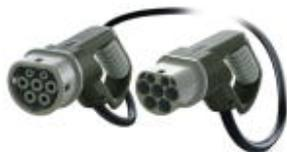
Мобильный зарядный кабель переменного тока с автомобильным зарядным и инфраструктурным штекерами, с защитными колпачками, Designlinie 1, Тип 2, МЭК 62196-2, 32 А / 480 В (AC), тип конструкции D-Line, кабель: 4 м, черный, прямой, поверхность сопряжения: серый, область захвата: серый
