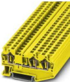
Проходные клеммы, номинальное напряжение: 800 В, номинальный ток: 32 А, тип подключения: Пружинный зажим, количество точек подсоединения: 3, сечение: 0,08 мм<sup>2</sup> - 6 мм<sup>2</sup>, AWG: 28 - 10, ширина: 6,2 мм, цвет: желтый, тип монтажа: NS 35/7,5, NS 35/15
