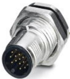
Встраиваемый соединитель для датчика/исп. устр-ва, штекер, 17-контактн., M12-SPEEDCON, экранированный, с мех. ключом А, монтаж на задней панели / резьбовое крепление M16, с прямыми выводами под пайку
