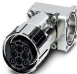
Приборный соединитель, передняя часть стенки, с накатанной гайкой, угловой, жесткий, Винтовой зажим, M40, полюсов: 4+3+PE, тип контактов: Розетка, Обжим, Аксиальное уплотнительное кольцо, 4x Ø4,2, экранирован.: есть, размер фланца: 40 мм x 40 мм
