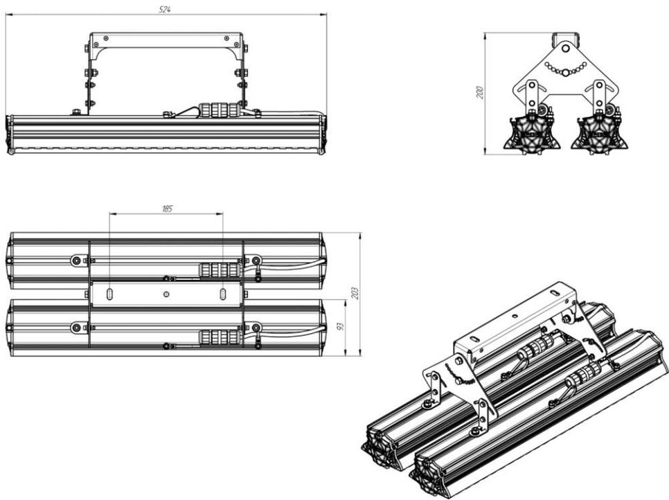
Рисунок 2 Светильник «L-industry 60 Turbine» x2
