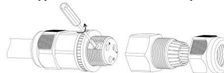
5. Продеть кабель через крышку с зажимной гайкой. Защищенные провод вставить в отверстие на разъеме так, чтобы только оголённая часть провода оказалась внутри клеммы. Подключение проводов в разъеме производить строго в соответствии с обозначением на торцевой поверхности центральной части коннектора. Закрепить провода в клеммах закрутив винты клемм.
