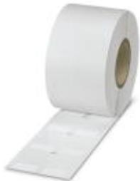
Этикетка-маркер для кабелей, рулон, белый, без маркировки, маркируется с помощью: THERMOMARK ROLLMASTER 300/600, THERMOMARK X1.2, THERMOMARK ROLL X1, THERMOMARK ROLL 2.0, THERMOMARK ROLL, тип монтажа: склеивание, диаметр кабеля: ≤ 14 мм, размер маркировочного поля: 38 мм x 19 мм
