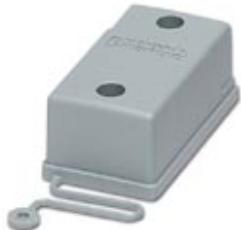
Защитная крышка VARIOCON для сальникового корпуса, степень защиты IP50, исполнение 1, макс. момент затяжки 1,6 Нм
