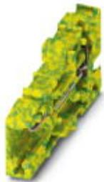
Соединитель COMBI, номинальное напряжение: 800 В, номинальный ток: 32 А, тип подключения: Пружинный зажим, количество точек подсоединения: 2, полюсов: 1, сечение: 0,08 мм<sup>2</sup> - 6 мм<sup>2</sup>, AWG: 28 - 10, ширина: 6,2 мм, высота: 22,3 мм, цвет: желто-зел.
