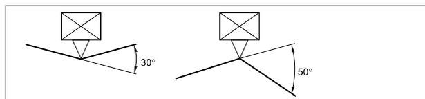
При монтаже проводов нейтрали на подвесах или зажимах не допускайте изгиба проводов на углы больше:
