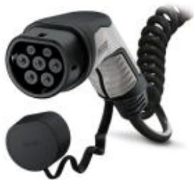
Зарядный кабель переменного тока с автомобильным зарядным штекером, без разъема, с защитным колпачком, C-Line черный / серый, Тип 2, МЭК 62196-2, 20 А / 250 В (AC), тип конструкции C-Line, кабель: 4 м, черный, спираль, поверхность сопряжения: черный, область захвата: серый
