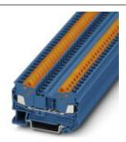
Проходные клеммы, номинальное напряжение: 800 В, номинальный ток: 24 А, тип подключения: Быстрое подключение, количество точек подсоединения: 2, сечение:  $0.5 \text{ мm}^2$  -  $2.5 \text{ мm}^2$ , AWG: 20 - 14, ширина: 6.2 мм, цвет: синий, тип монтажа: NS 35/7.5, NS 35/15
