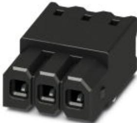
Корпусная часть для печатных плат, номинальный ток: 6 A, расчетное напряжение (III/2): 160 В, полюсов: 8, размер шага: 2,5 мм, цвет: черный, поверхность контакта: олово, монтаж: THR пайка, Артикул с защитными стопорными штифтами
