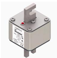
Предохранитель, высокая скорость, 500 A, AC 690 V, DIN 2, 61 x 61 x 108 мм, aR, DIN, IEC, одинарный индикатор
