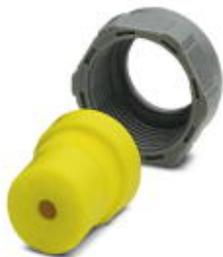
Резьбовой сальник Pg16 с частично нарезанной резьбой, пластмассовый, в комплекте с резиновым уплотнением с одним отверстием и прижимной винтовой деталью, для корпусов исполнения 1, кабель (мм) 7-14
