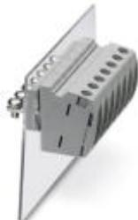
Проходная клемма, тип подключения: Винтовые зажимы, Подсоединение кабельного наконечника, полюсов: 1, ток нагрузки: 101 A, сечение: 6 mm<sup>2</sup> - 25 mm<sup>2</sup>, AWG 10 - 4, угол между направлениями подключения провода и установки разъема: 0 °, ширина: 12,1 мм, цвет: серый
