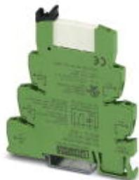
PLC-INTERFACE, состоит из основной клеммы для монтажной рейки с винтовым зажимом и вставным миниатюрным реле с силовым контактом, 1 перекл. контакт, входное напр. 12 В DC, UL/cUL: допуск для применения во взрывоопасной зоне, класс I, разд. 2
