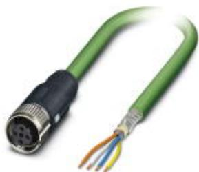
Сетевой кабель, PROFINET CAT5 (100 Мбит/с), EtherCAT® CAT5 (100 Мбит/с), 4-полюсн., ПВХ/ПВХ, зеленый RAL 6018, экранирован., свободный конец, к гнезду прямое M12 SPEEDCON / IP67, механические ключи: D, длина кабеля: 2 м
