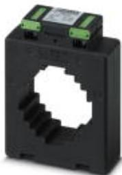
Шинный трансформатор, первичный ток 500 А AC; вторичный ток 5 А AC; класс точности 1; номинальная мощность 5 ВА.
