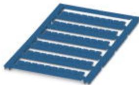
Материалы UniCard для термопечатающего принтера, для маркировки клемм с плоскими пазами Weidmüller, Conta Clip и Klemsan, 60 элементов, надписи наносятся при помощи принтеров THERMOMARK CARD и BLUEMARK LED, цвет: синий
