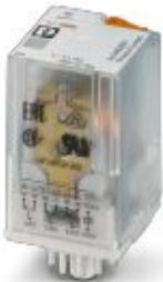
Вставное восьмиконтактное реле с силовыми контактами, 3 переключающих контакта, испытательная кнопка, механическая индикация положения включения, напряжение на катушке: 24 В AC
