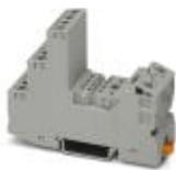
Цоколь реле RIF-2..., для промышленных реле с 2 или 4 переключающими контактами, винтовой зажим, возможность установки входных модулей/модулей подавления помех, для монтажа на NS 35/7,5
