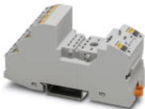
Цоколь реле RIF-2.../EX для комплектации герметичными (RTIII) промышленными реле с 4 переключающими контактами для использования в зоне 2, зажим push-in, возможность установки входных модулей и модулей подавления помех, для монтажа на NS 35/7,5
