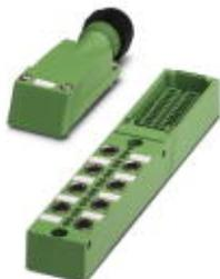
Коробка датчика и исполнительного элемента, применение: Стандартн., тип подключения: Розетка M8 металл, количество гнезд: 8, полюсов: 3, механические ключи: А - стандарт, гнездо для платы: один ряд, индикатор состояния: есть, р-п-р; подключение магистрального кабеля: вставные винтовые клеммы 180°, экранировка: нет
