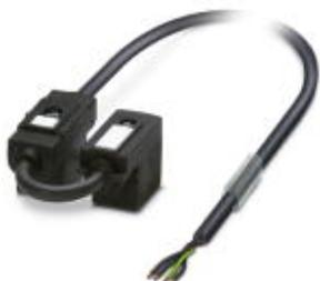
Кабель двойного разъема клапана, 4-полюсн., PUR/ПВХ, черный, свободный конец, к Штекер типа В для электромагнитного клапана (10 мм), с 1 светодиод, подключение с помощью Диод Зенера и Штекер типа В для электромагнитного клапана (10 мм), с 1 светодиод, подключение с помощью Диод Зенера, длина кабеля: 3 м, расстояние штекера для клапана: 0,1 м
