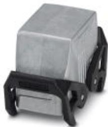
Сальниковый корпус В10, с двумя защелками, материал: Из алюминия, методом литья под давлением, стойкий к морской воде, на заказ, высота: 57 мм, кабельный ввод: без, патрубков: Нет, Стандартн., без резьбового отверстия для завинчивания
