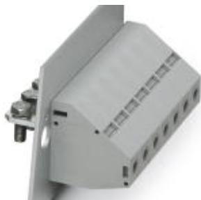
Проходная клемма, тип подключения: Винтовые зажимы, Болтовые клеммы, полюсов: 1, ток нагрузки: 150 A, сечение: 16 mm<sup>2</sup> - 50 mm<sup>2</sup>, AWG 6 - 1/0, угол между направлениями подключения провода и установки разъема: -90°, ширина: 18,8 мм, цвет: серый
