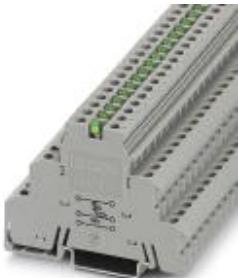
Клеммный модуль для подключения датчиков и исполнительных элементов, тип подключения: Винтовые зажимы, сечение: 0,2 мм<sup>2</sup> - 4 мм<sup>2</sup>, AWG: 24 - 12, ширина: 6,2 мм, цвет: серый, тип монтажа: NS 35/7,5, NS 35/15
