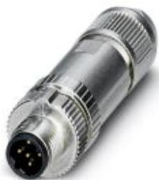
Разъем, 5-полюсн., экранирован., Штекеры прямое M12, В-кодирование, Зажимы Push-in, материал накатанной гайки: Цинк. литья под давлением, с никелевым покрытием, наружный диаметр кабеля 4 мм ... 8 мм
