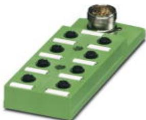
Коробка датчика и исполнительного элемента, применение: Стандартн., тип подключения: Розетка M12 Пластик, количество гнезд: 8, полюсов: 5, механические ключи: А - стандарт, гнездо для платы: Двойной, индикатор состояния: Нет, Универсальный; подключение магистрального кабеля: Штекерный разъем M 23 90°, экранировка: нет
