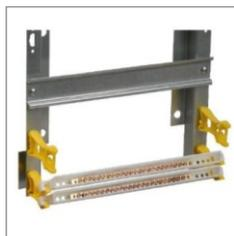
Шины N и PE защелкиваются в держатели стоек, которые устанавливаются в гнезда монтажных профилей при помощи зацепов. Удобный подвод кабеля.
