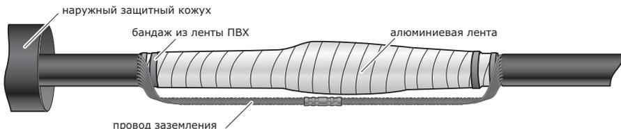
5.1 Поверх изолирующей манжеты произвести намотку алюминиевой экранирующей ленты с перехлестом витков 15-20 мм. Для кабелей с броней (или ленточным экраном) намотку осуществлять с заходом на броню кабеля 10 мм.
