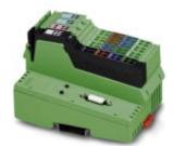
Inline, Устройство сопряжения с шиной, Modbus/RTU, Гнездо D-SUB-9, Цифровые входы: 8, 24 В DC, способ подключения: 3-проводная схема, Цифровые выходы: 4, 24 В DC, 500 мА, способ подключения: 3-проводная схема, скорость передачи данных в локальной шине: 500 кбит/с / 2 Мбит/с, степень защиты: IP20, включая штекеры Inline и поля для маркировки
