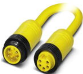
Силовой кабель, 5-полюсн., ПВХ, желтый, Штекеры прямое 7/8"-16UNF, к Гнездо прямое 7/8"-16UNF, длина кабеля: 5 м
