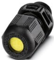
Кабельный ввод, материал резьбового соединения: PA, применение: Ex, наружный диаметр кабеля 3 мм ... 6 мм, экранировка: нет, резьба соединительной части: M12 x 1,5, цвет: иссиня-чёрный RAL 9005, с плоским уплотнителем
