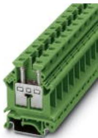
Проходные клеммы, номинальное напряжение: 800 В, номинальный ток: 76 А, тип подключения: Винтовые зажимы, количество точек подсоединения: 2, сечение: 2,5 мм<sup>2</sup> - 25 мм<sup>2</sup>, AWG: 14 - 4, ширина: 12,2 мм, цвет: зеленый, тип монтажа: NS 35/7,5, NS 35/15, NS 32
