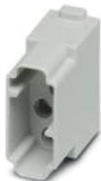
Модуль для установки контактов, полюсов: 4xKOAX, контакты цепи питания: 0, контакты цепи управления: 4, Штифт, Вывод под пайку и обжимной контакт, 50 В, 2 А, 0,14 мм<sup>2</sup> ... 2,5 мм<sup>2</sup>, применение: Сигнал
