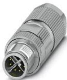
Разъем, Ethernet / PROFINET CAT6<sub>A</sub> (10 Гбит/с), 8-полюсн., экранирован., Штекеры прямое M12, X-кодирование, Обжим, материал накатанной гайки: Цинк. литья под давлением, с никелевым покрытием, наружный диаметр кабеля 6,5 мм ... 10 мм, без обжимаемых контактов
