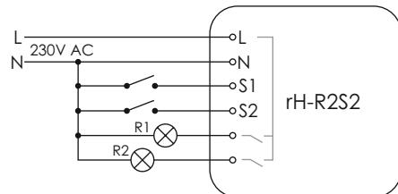
шина L, N – питание реле и нагрузки
