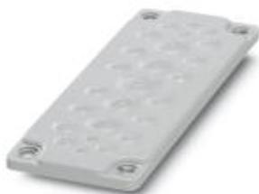
Панель кабельных вводов, количество проводов: 25, длина: 222 мм, ширина: 92 мм, высота: 14 мм, наружный диаметр проводника: 4x 5 мм ... 7 мм, цвет: серый
