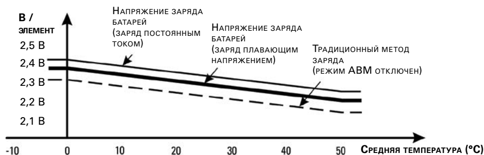
Температурная компенсация. Зависимость напряжения заряда от температуры.
