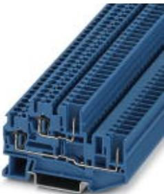
Двухъярусные клеммы, тип подключения: Штекерное соединение / пружинный зажим, сечение: 0,08 mm<sup>2</sup> - 4 mm<sup>2</sup>, AWG: 28 - 12, ширина: 5,2 мм, цвет: синий, тип монтажа: NS 35/15, NS 35/7,5
