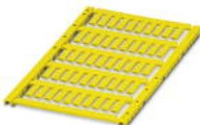
Маркировка для проводов, Пластина, желтый, без маркировки, маркируется с помощью: TOPMARK NEO, TOPMARK LASER, BLUEMARK ID COLOR, BLUEMARK ID, BLUEMARK CLED, THERMOMARK PRIME, THERMOMARK CARD 2.0, THERMOMARK CARD, тип монтажа: вставить, диапазон диаметра кабеля: 0,6 ... 10 мм, размер маркировочного поля: 12 x 4 мм
