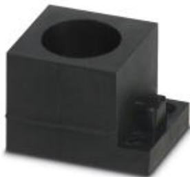
Кабельный сальник, количество проводов: 1, длина: 29,5 мм, ширина: 19,5 мм, высота: 17 мм, наружный диаметр проводника: 1x 16 мм ... 17 мм, цвет: черный
