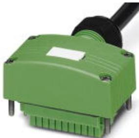
Разъем с кабелем, применение: Концентратор сигналов датчиков и исполнительных элементов, тип подключения: Гнездовой разъем M12-SPEEDCON металл, количество гнезд: 8, гнездо для платы: один ряд, индикатор состояния: Нет; подключение магистрального кабеля: вставные винтовые клеммы 180°, PUR/PVC, длина кабеля: 10 м, экранировка: нет
