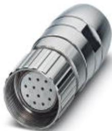
Кабельный соединитель, прямой, экранирован.: есть, Винтовой зажим, M23, Полосов: 16+2+PE, тип контактов: Розетка, Обжим, диапазон диаметра кабеля: 11,5 мм ... 13,5 мм
